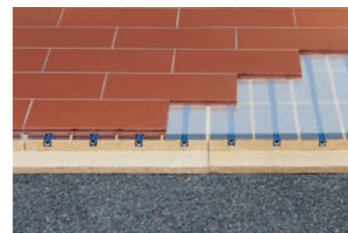
Estrichziegel auf Fußbodenheizung als „Öko-System“ mit Rohren und Wärmeleitblechen in Holzweichfaser-Dämmung (z.B. PAVATEX „PAVAPOR 22/21 oder 17/16“) und TONALITY-Trockenschüttung.
