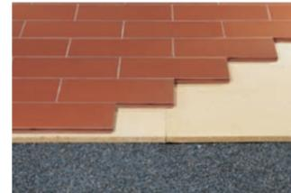
Estrichziegel auf Holzweichfaser-Trittschalldämmung (z.B. PAVATEX „PAVAPOR 22/21 oder 17/16“) auf TONALITY-Trockenschüttung.
