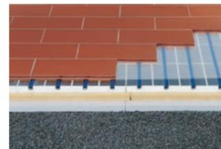
Estrichziegel auf Fußbodenheizung. Trittschalldämmung aus Holzweichfaser (z.B. PAVATEX „PAVAPOR 22/21 oder 17/16“), Hartschaumdämmung EPS und TONALITY-Trockenschüttung.
