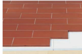
Estrichziegel auf EPS 035 DEO L 200 kPa und Holzweichfaser-Trittschalldämmung (z.B. PAVATEX „PAVAPOR 22/21 oder 17/16“) auf TONALITY-Trockenschüttung.
