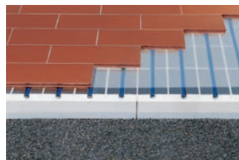
Estrichziegel auf Fußbodenheizung. Geeignetes System mit Rohren in Wärmeleitblechen und Hartschaumdämmung EPS 035 DEO M 200 kPa auf TONALITY-Trockenschüttung für planebenen Untergrund.
